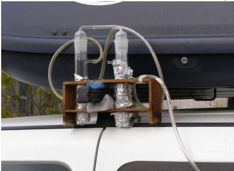
La concentrazione di acido cloridrico in aria è risultata di 0.009 mg per metro cubo di aria (9 µg/mc) che può essere confrontata con il valore di concentrazione considerevolmente più elevato permesso in ambiente di lavoro che è di 7,5 mg/mc. La concentrazione di HCN è risultata inferiore al limite di rilevabilità strumentale.
