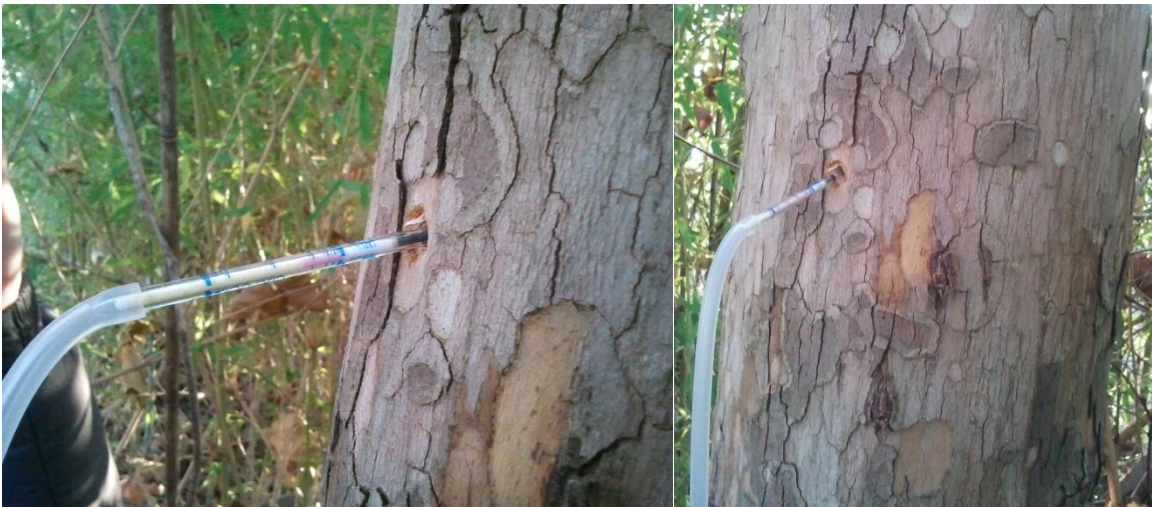
Figura 4 Fiala inserita nel foro precedentemente realizzato per il prelievo di campione di albero. Si può notare il tubo in Teflon che collega la pompa alla fiala.
