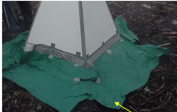
**Figura 10: Particolare della cappa statica e dei fogli di materiale plastico da disporre intorno alla bocca di presa.**
