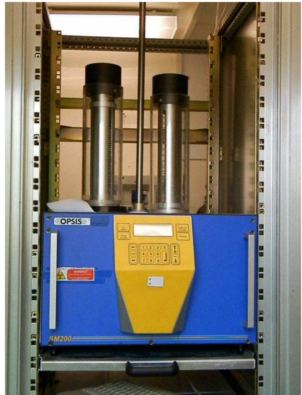
Campionatore – Misuratore di Particolato in Atmosfera – Opsis SM200
