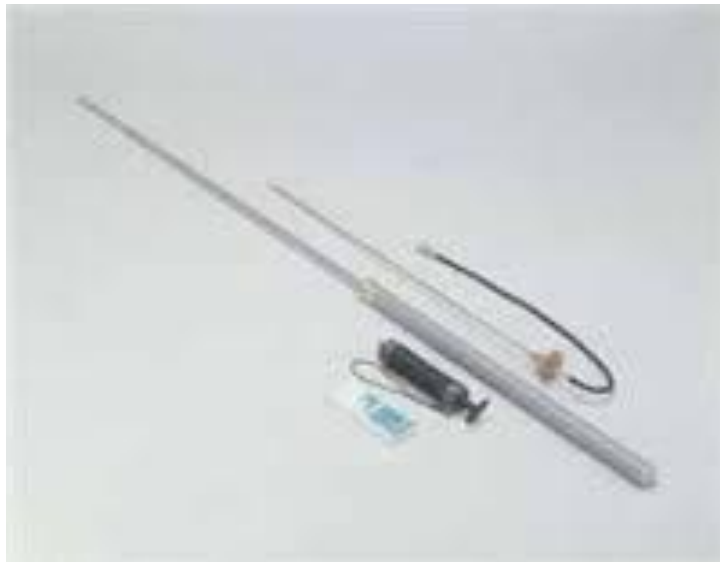
Figura 13 Sonda perforatrice e campionatrice temporanea
