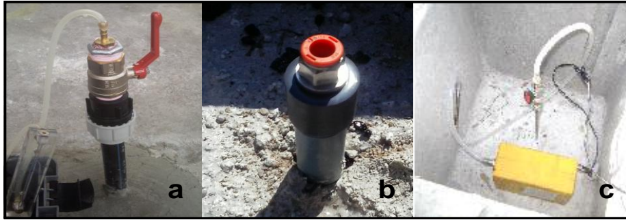
Figura 11 Tipologie di sonde e sistemi di chiusura per il prelievo dei soil gas in PVC con diametro da 2,5 cm (a) in PVC con diametro di 12 mm (b) ed in acciaio con diametro da 6mm (c).
