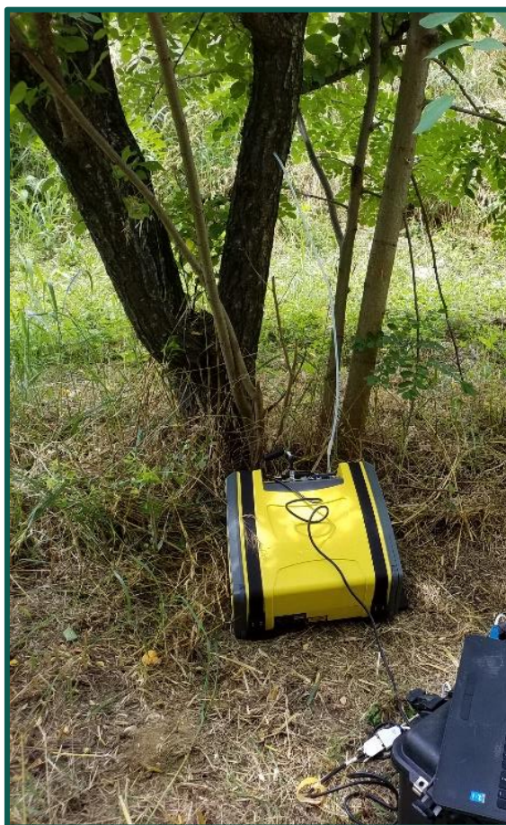
Figura 11 Campionamento in vivo tramite FT-IR
