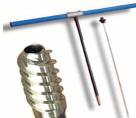
Figura 4 Succhiello di Pressler o campionatore incrementale (Vroblesky, 2008).
