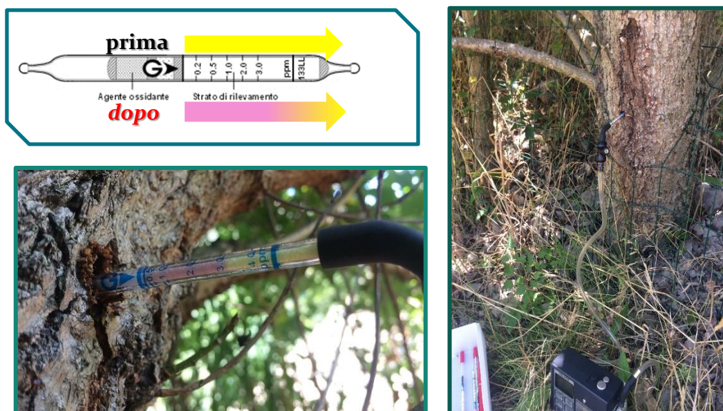
Figura 8 Campionamento in vivo tramite fiala colorimetrica
