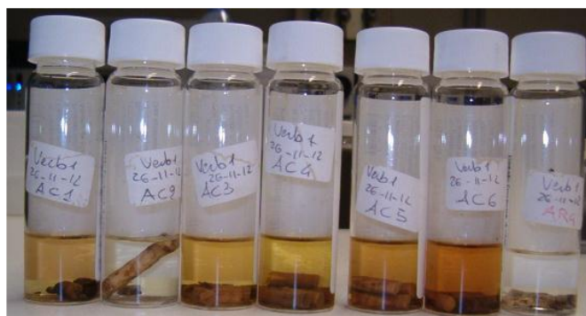
Figura 7 Vial con setto in teflon utilizzato per la conservazione del campione.
