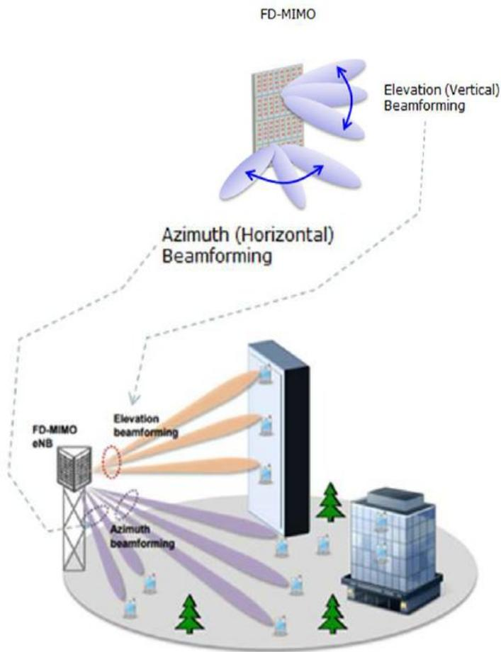
L'antenna Massive MIMO consente di direzionare il fascio sia sul piano orizzontale che verticale
