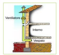
un ventilatore. In alcuni casi la semplice pulizia delle bocchette di aerazione presenti porta a un abbassamento della concentrazione di radon.
